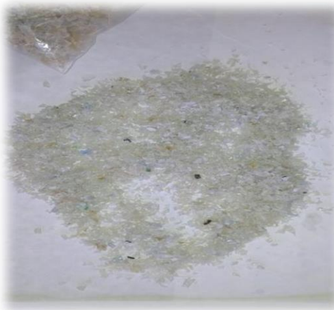
Čirý flake s blokátorem (po tepelném testu)
