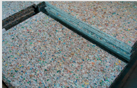
Stavební desky z recyklovaných nápojových kartonů
