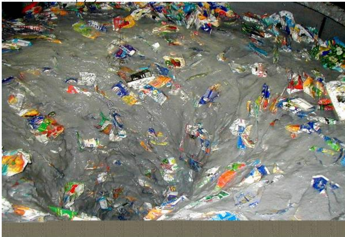
Obr. 1. Zpracování nápojových kartonů rozvlákněním
